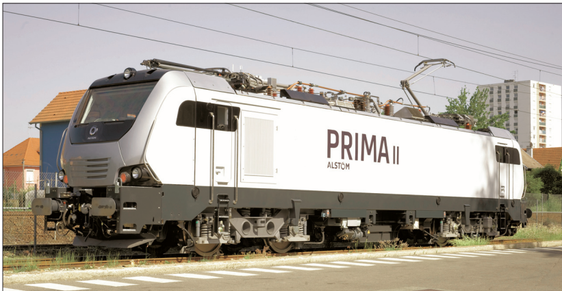
21. ábra A Prima II. kétrendszerű, négyfeszültségű, négy áramszedős villamos mozdony Abbildung 21 Die Prima II. vier Spannung Elektrische Lokomotive mit vier Stromabnehmern Figure 21. The Prima II. dualsystem, four-voltage, four collector electric locomotive Fotó: Alstom
