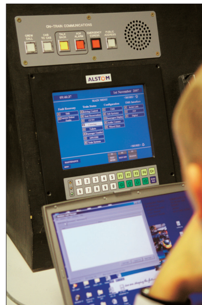
13. ábra Vonatkommunikáció ellenőrzése, lekérdezése
