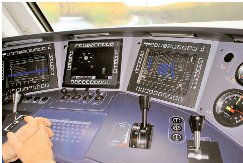
26. ábra A Prima II. vezetőpult látványa vontatás közben
