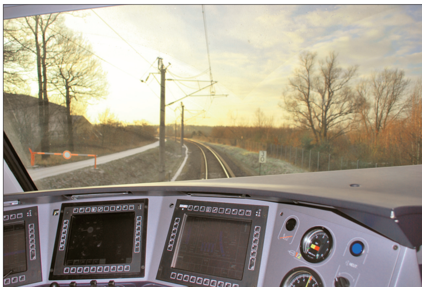
24. ábra A vezetőpult részlete jól áttekinthető 4 színes monitorral Abbildung 24 Der Lokomotivführerstand. Detailansicht mit vier farbigen Bildschirmen Figure 24. Detail of driver counter with a fine perspicuous 4 colour monitor Fotó: Kovács Károly
