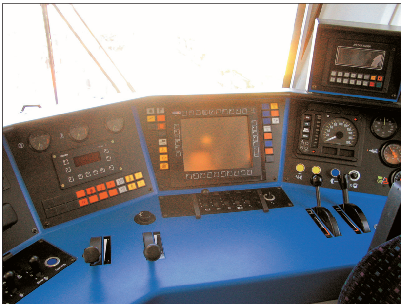
19. ábra A Maxima mozdony vezetőállás részlete
