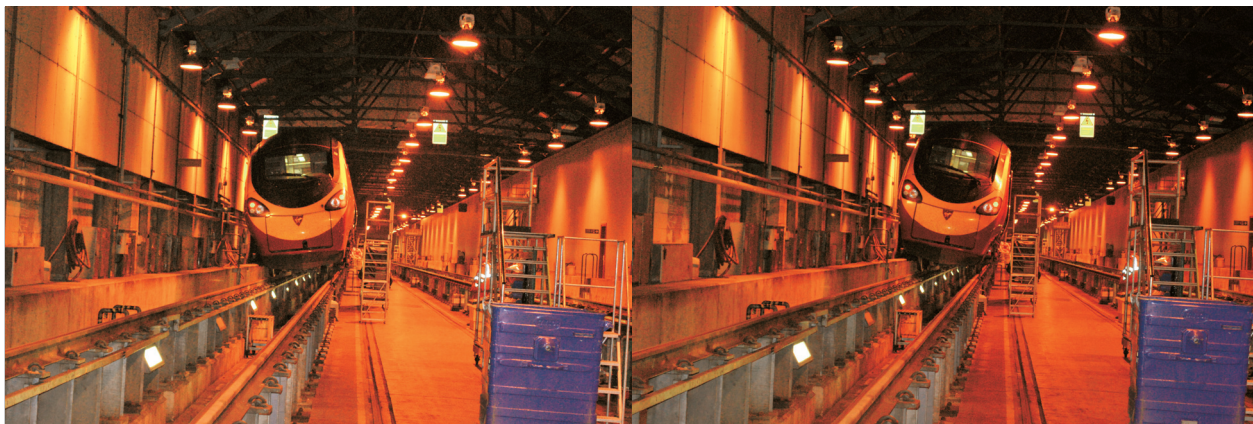
4. ábra A Virgin Pendolino vonat billentő szerkezetének állópróbája billentés jobbra, majd balra
