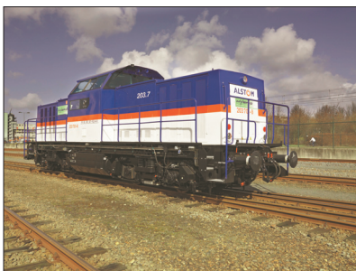
13. ábra Az Alstom hibrid üzemű tolatómozdonya
