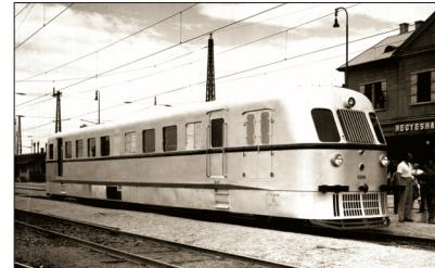
5. ábra Árpád rendszerű lékgondicionált utasterű motorkocsik először az Egyptomi Államvasutak megrendelésére készültek
