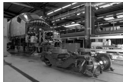
15. ábra Szinkron motoros forgóvázak készülnek az AGVTM-hez az Alstom's Le Creusot-i üzemében
