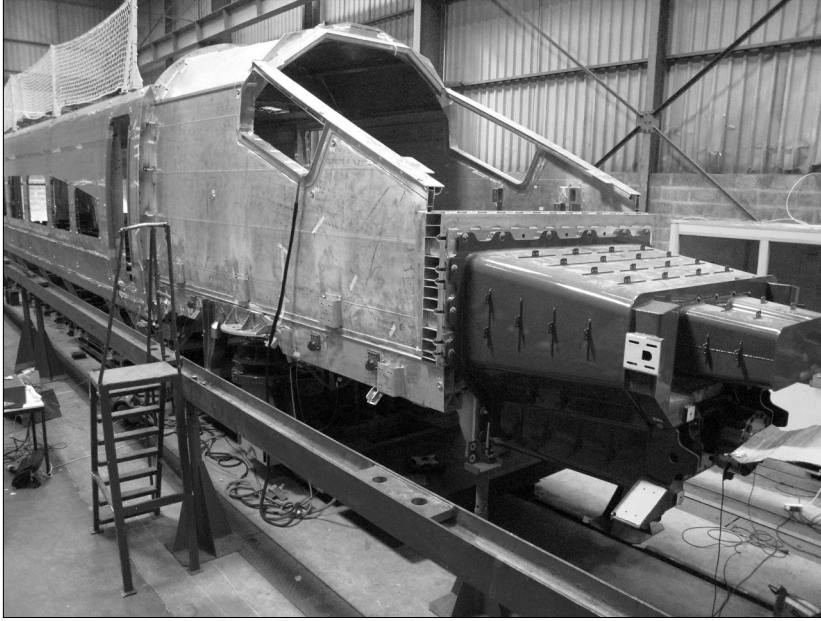
3. ábra Az AGV első prototípus kocsiszekrényének részlete Fig. 3. A part of the first AGV prototype's body shell
