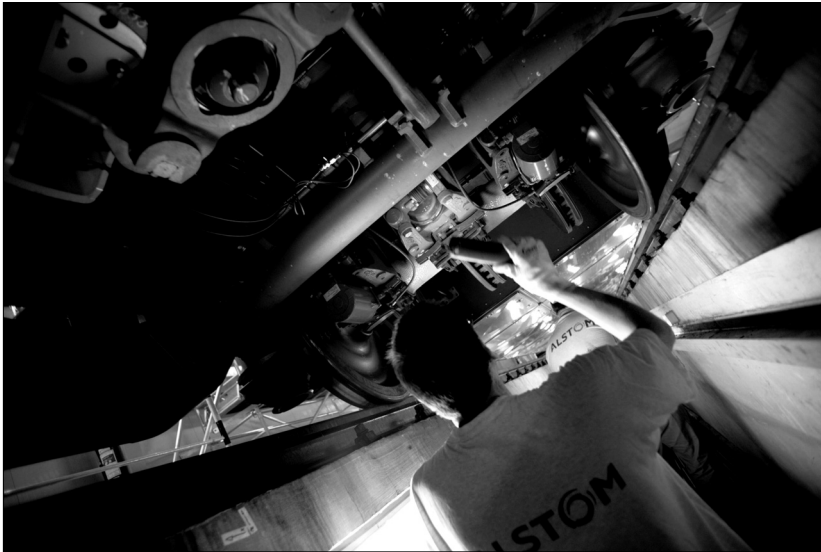
10. ábra A hajtáslánc és a fékrendszer működésének helyességét álló helyzetben is ellenőrizték
