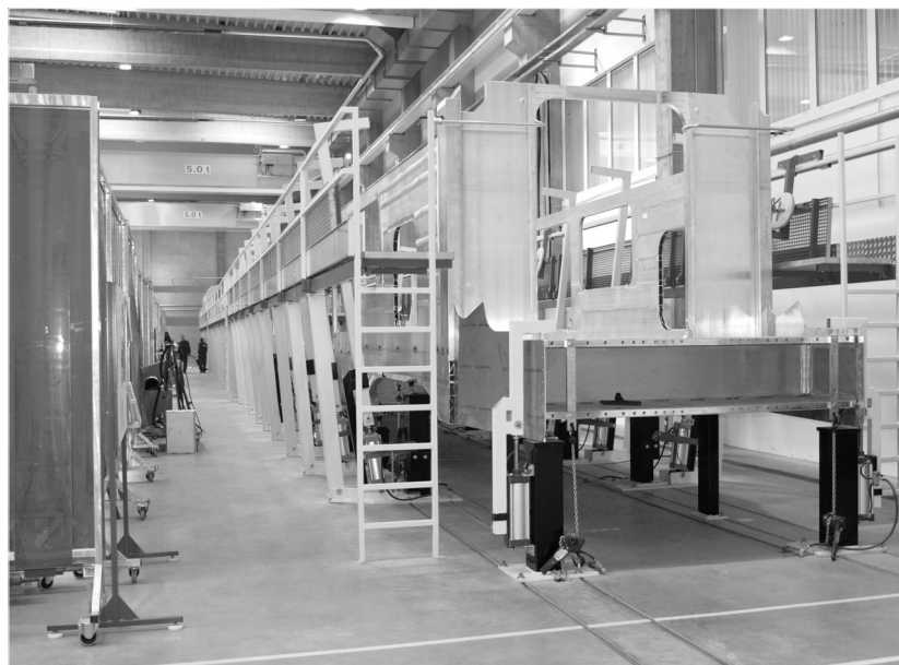
4. ábra Alumínium kocsiszekrények gyártása FLIRT motorvonatokhoz
