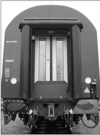
16. ábra Kocsivég a LED-es zárlámpákkal
