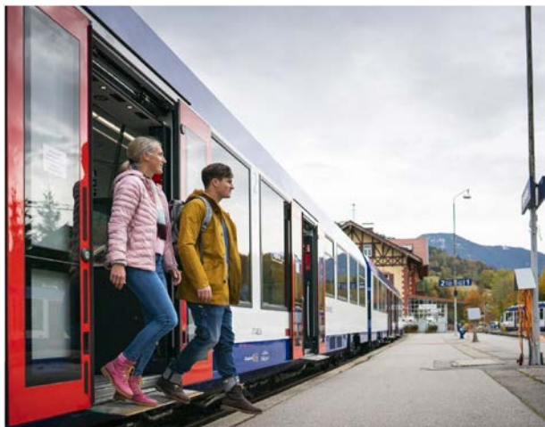
4.ábra: Az INTEGRAL Az utascella ajtaja ki-beszállás változó állomási peronmagasság esetében
