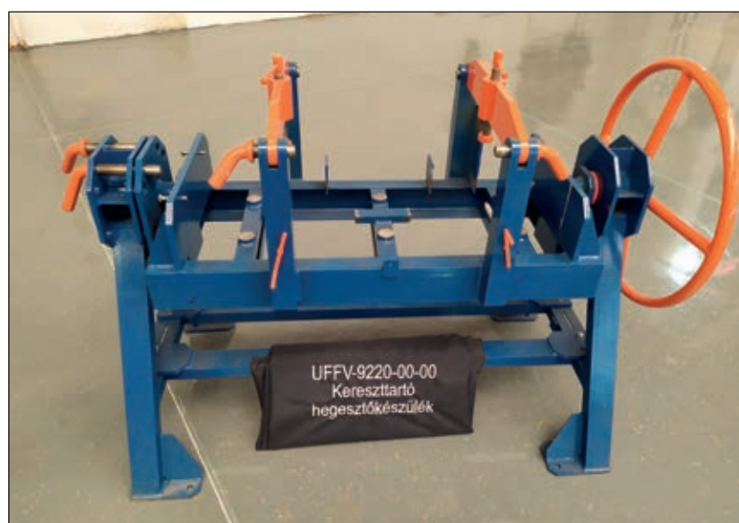
3. ábra: Kereszttartó hegesztőkészülék
