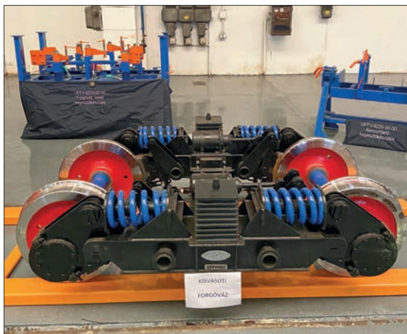
2. ábra: Univerzális kisvasúti futó forgóváz (UFFV)
