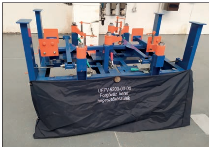
5. ábra: Forgóváz keret hegesztő készülék
