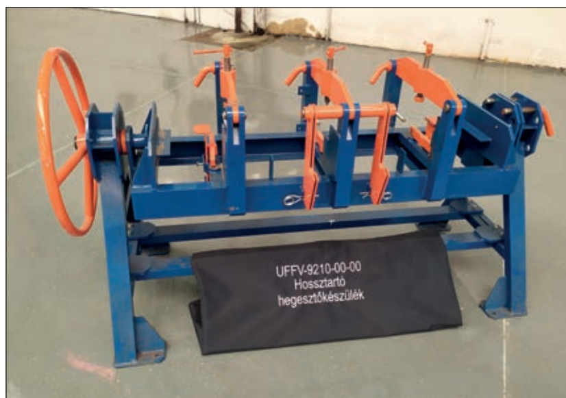
4. ábra: Hosszartó hegesztő készülék
