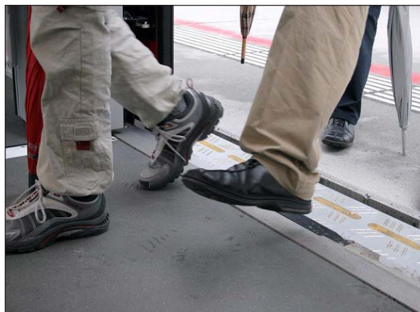
7. ábra: A lépcsőtoldás kimozduló lépcsőelem
