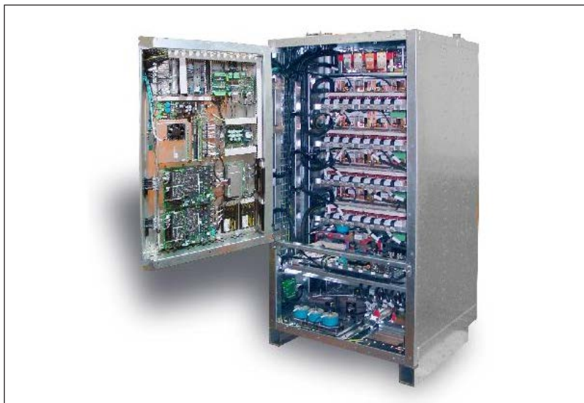
9. ábra: ABB Bordline-CC750-es átalakító
