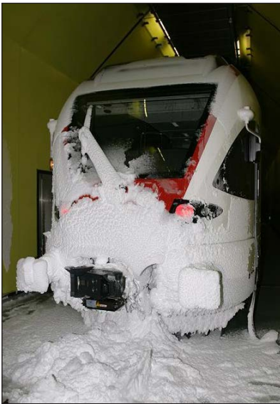
4. ábra: A Wien Arsenal a FLIRT hidegpróba
