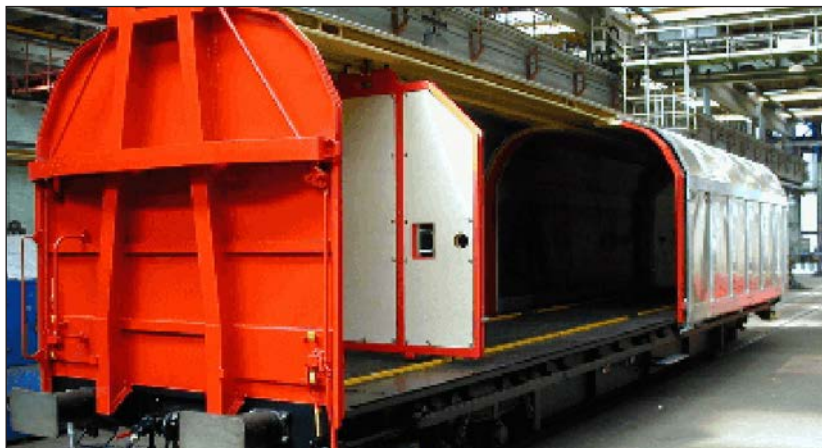
12. ábra: Debrecenben gyártott 2 tengelyes eltolható oldalfalú kocsik (Fotó: Grampet)
