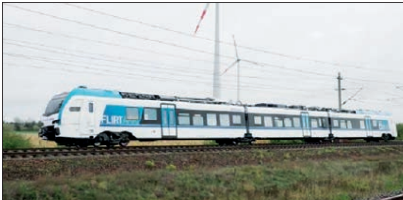
8. ábra: A Stadler FLIRT-ACCU akkumulátoros üzemben 185 km megtételére képes
