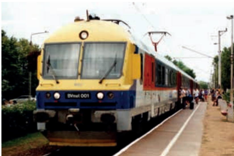
14. ábra: BVmot, a 25 éve gyártott első magyar aszinkron hajtásrendszerű IC villamos motorvonat
