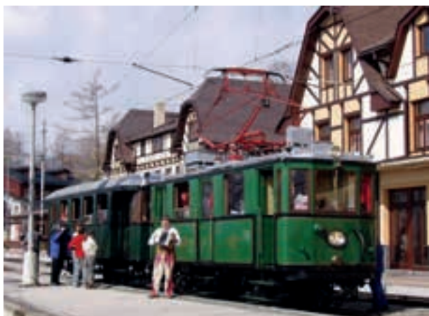
6. ábra: Az 1912-ben villamosított 1000 mm-es nyomtávú Tátrai villamosvasút Ganz gyártmányú TEVD 22 sorozatszámú motorkocsija
