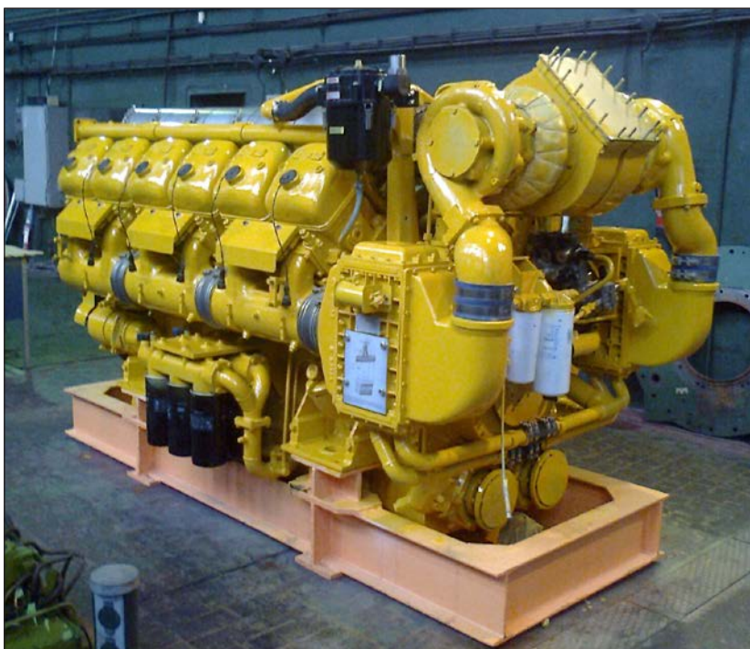
5. ábra: Az első CR motor (Fotó: Ganz Motor Kft)
