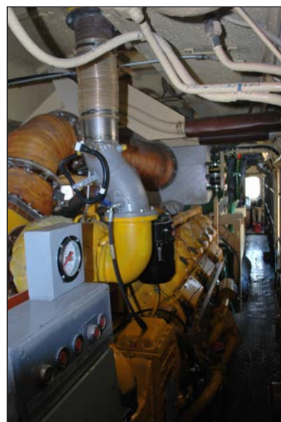
9. ábra: Az M41-es mozdony CR motor géptérben 2017-ben Dombóváron (Fotó: Kovács Károly)
